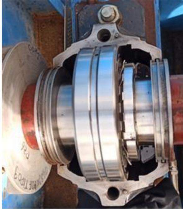
In questo caso è opportuno verificare che il sensore non superi mai la lavorazione sul supporto per l'alloggiamento dell'anello esterno del cuscinetto in quanto impedirebbe l'adattamento del cuscinetto, in modo particolare di quello libero, generando potenziali danneggiamenti sia al sensore che alla macchina.
